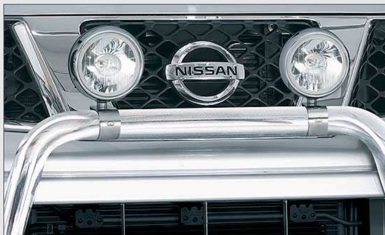
Držák přídavného světla na trubku pr.76 mm 2ks - nerez
