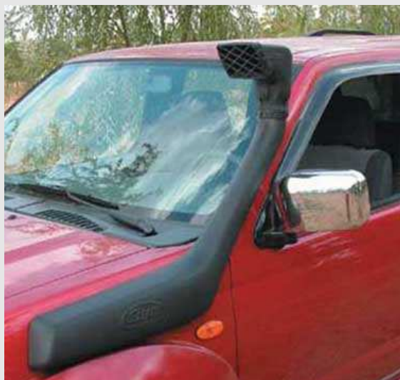
Zvýšené sání – šnorchl vhodný doplněk pro brodění
