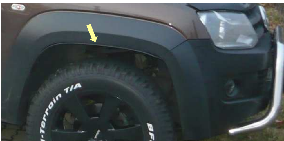
Vnitřní ochranné lemy blatníků – pružné chrání před odletujícími kameny a zabraňuje nalepování sněhu
